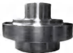
Обточенные штамповки дисков из сплава ЭП742-ИД. Заказчик ОАО «ОМКБ»
